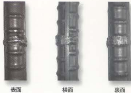
裏当て材を使用しないため、継手部は、全周外観確認可能です
